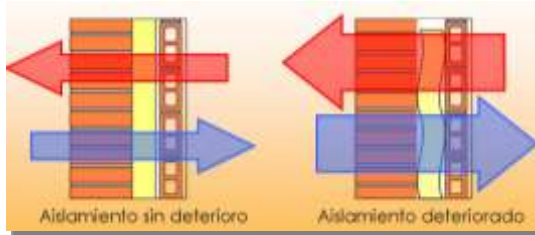
Disminución de la capacidad aislante por efecto del deterioro.
