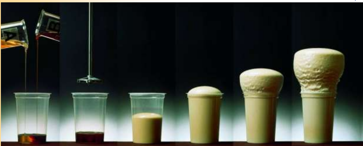
Proceso de espumación del poliuretano: Los componentes son mezclados y agitados hasta su homogenización, e inmediatamente se inicia la reacción química que genera la espuma rígida. En los sistemas de proyección, la reacción se completa en unos 10 segundos.
