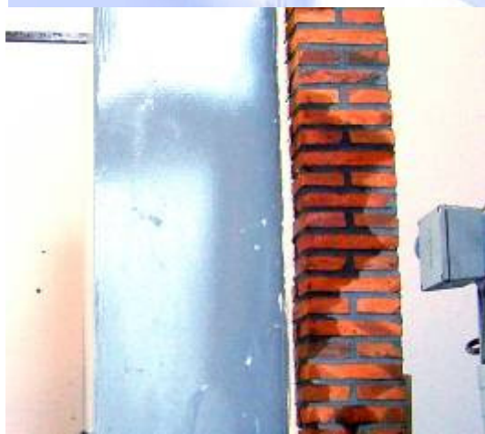
Vista lateral de la muestra tras el ensayo, donde se aprecia cómo el poliuretano se comportó como una barrera contra el agua, aún cuando ésta llegó a saturar el ladrillo y el mortero.
