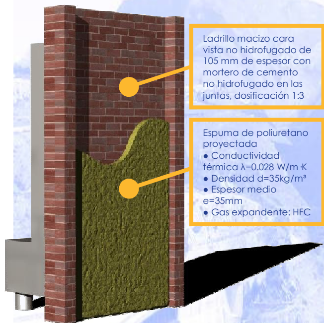
Solución constructiva ensayada para cumplir con la máxima exigencia de impermeabilidad.
