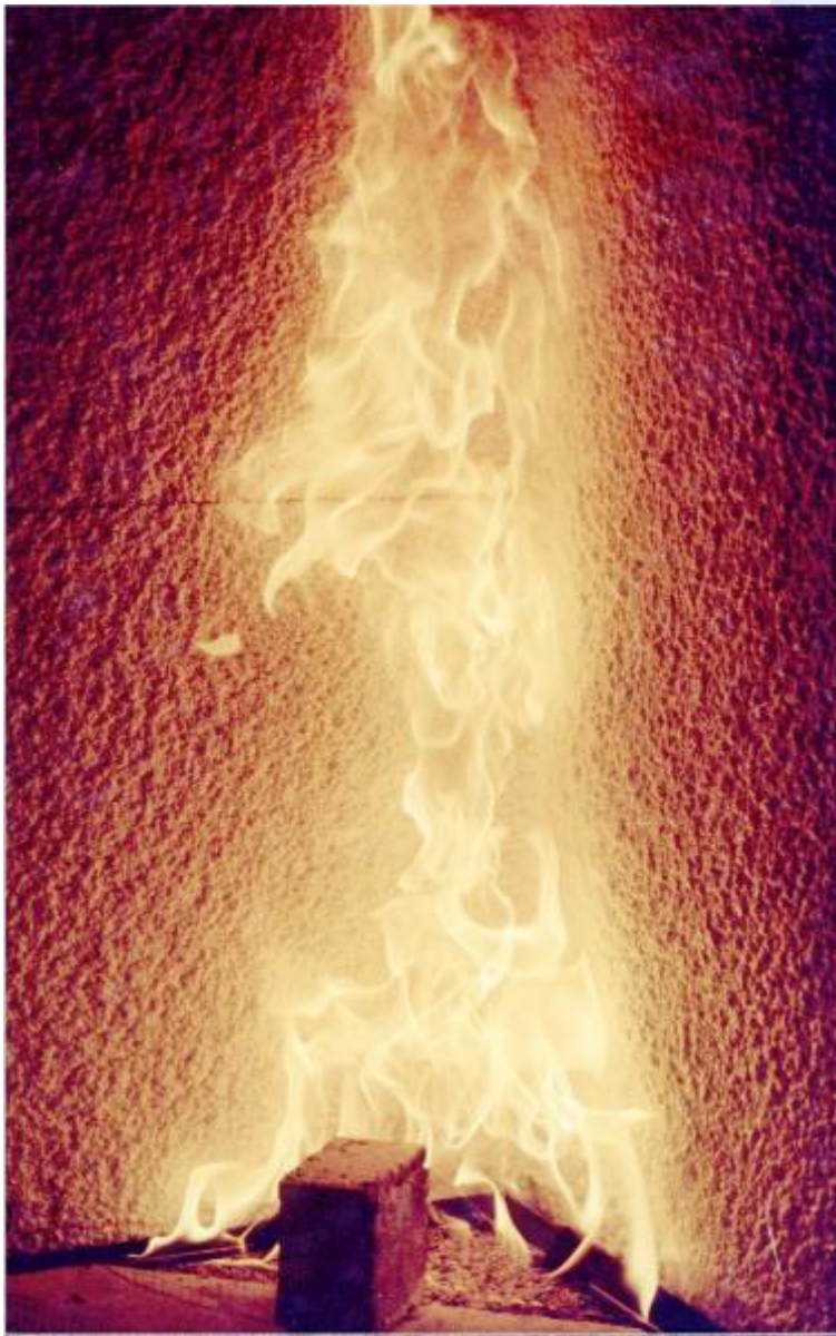
Probeta de poliuretano proyectado montada en el aparato de ensayo del SB, para su clasificación al fuego en Euroclases.
